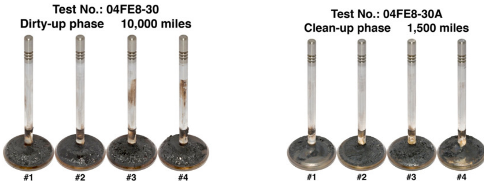
Soupapes d'admission du Ford Explorer
